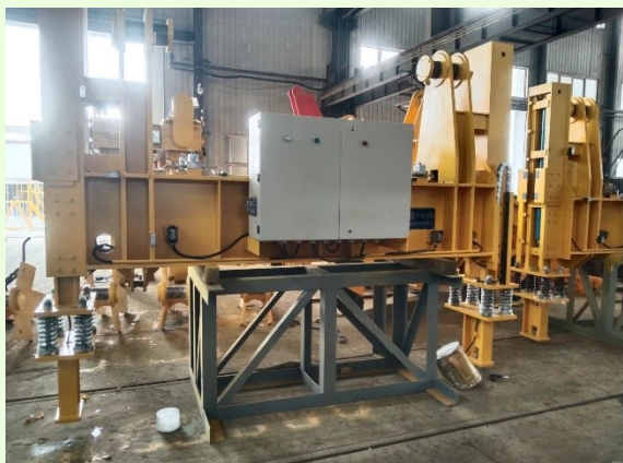
吊具の Top Beam と Bottom Arm を分けて出荷、現地で組立てる
