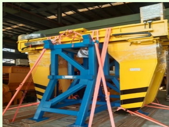
吊具の Top Beam と Bottom Arm を分けて出荷、現地で組立てる
